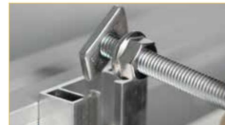
**2** Schrauben Sie eine Sperrzahnmutter und eine Gewindeplatte auf einen Gewindebolzen und führen Sie diese in das Aluprofil ein. Wiederholen Sie den Vorgang bis in jedem Profil vier Gewindebolzen eingeschoben sind.
