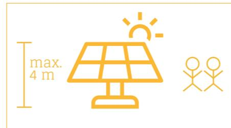
Die Oberkante der Installation darf eine Höhe über der Verkehrsfläche von 4 m nicht überschreiten. Das PV-Module sollte an einem Ort mit möglichst viel Sonneneinstrahlung installiert werden. Wie empfohlen die Montage mit 2 Personen.
