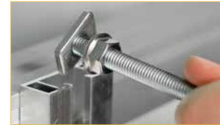
**1** Schrauben Sie eine Sperrzahnmutter und eine Gewindeplatte auf einen Gewindebolzen und führen Sie diese in das Aluprofil ein. Wiederholen Sie den Vorgang bis in jedem Profil vier Gewindebolzen eingeschoben sind.
