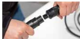
**1** Kabel zur Verbindung des Wechselrichters mit dem Anschlusskabel an das Hausnetz
