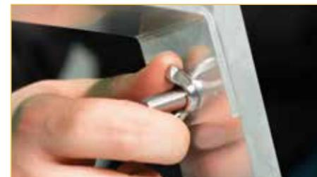
**1** Klappen Sie die Alu-Winkel auseinander und legen Sie den optimalen Neigungswinkel fest (s. linke Seite). Befestigen sie die Mittelschiene mit M8x35 Hammerkopfschraube und Flügelmuttern.
